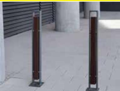
Anlehnbügel aus Flachstahl 60 x 10 mm feuerverzinkt, optional mit Pulverbeschichtung. Standardfarbe anthrazit-eisenglimmer, ähnlich DB 703. Vertikal verschraubte Holzleiste aus Hartholz. Zum Anlehnen von Fahrrädern und leichten Anschließen des Fahrradrahmens. Auch als Absperrpfosten einsetzbar. Verlängert zum Einbetonieren, optional mit Bodenplatte.
